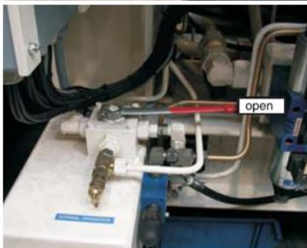
Afb: Handklep wegslepen voor hydraulische noodbediening
