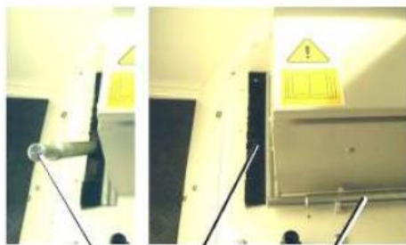
Emplacement levier de pompe manuelle
